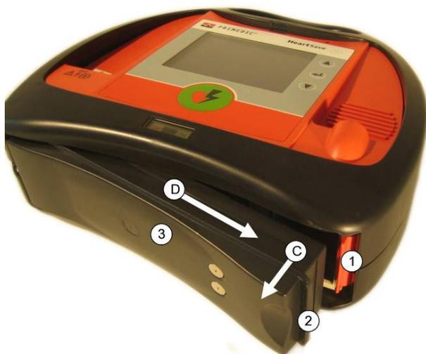
**Abb. 12: Energiemodul entnehmen**
