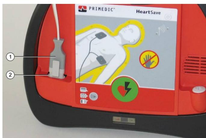
**Abb. 18: Elektrodenstecker einstecken**
