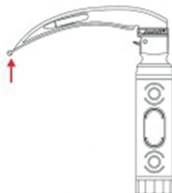
Fig. 3) Levantar la hoja arriba hasta que se bloquee con el mango
