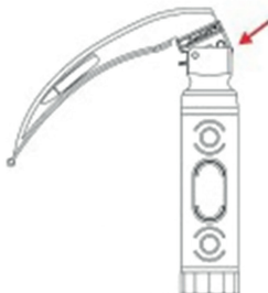
Fig. 2) Enganchar la cuchilla en el mango aplicando suficiente fuerza
